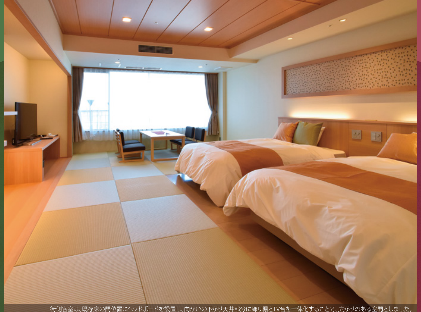
街側客室は、既存床の間位置にヘッドボードを設置し、向かいの下がり天井部分に飾り棚とTV台を一体化することで、広がりある空間としました。
